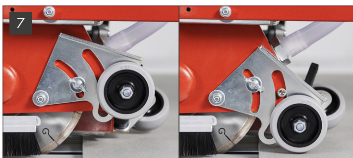
Ruote per il bloccaggio della piastrella/lastra durante i tagli a 90° (Fig. 7) e durante i tagli a 45° (jolly) (Fig. 8) Wheels stop the tile/slab during 90° cuts (Fig. 7) and during 45° miter-cuts (Fig. 8)
