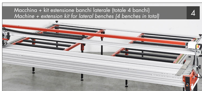
Fig. 1 - Segatrice a ponte per il taglio di lastre fino a 330 cm di lunghezza | Fig. 2 - Idonea anche per esecuzione jolly (taglio a 45°) Pic. 1 - Bridge wet-saw for cutting tiles/slabs up to 330 cm (10.8') length | Pic. 2 - Suitable also for 45° edge-miter cut (jolly)
