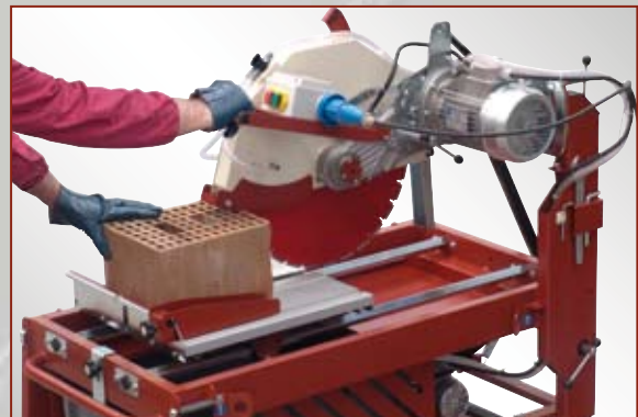
Profondità di taglio regolabile manualmente. Adjust depth of cut manually.
